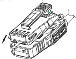
Нажмите на верхнюю часть аккумулятора в направлении радиостанции, когда он плотно встанет на место, послышится щелчок.
