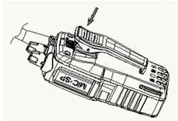
Для изъятия аккумулятора потяните вверх за защелку, затем вытащите батарею из радиостанции.
